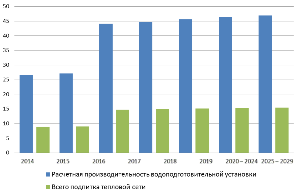
Рис. 4.14. Перспективная подпитка теплосети и расчетная производительность ВПУ котельной ОАО «ЭСП» на период 2015 – 2029 гг.
