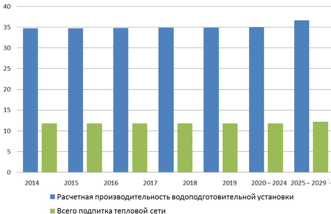
Рис. 4.12. Перспективная подпитка теплосети и расчетная производительность ВПУ котельной «Южная» на период 2015 – 2029 гг.
