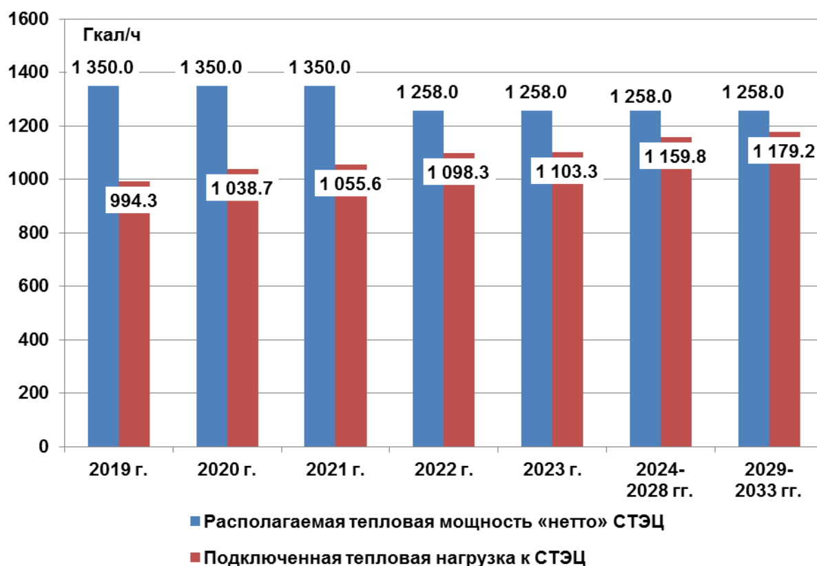
Рис. 1.5.10. Изменение резерва тепловой мощности «нетто» СТЭЦ в период 2019 – 2033 гг. при присоединении тепловых нагрузок 6-ти котельных с учетом мероприятий по энергосбережению у потребителей
