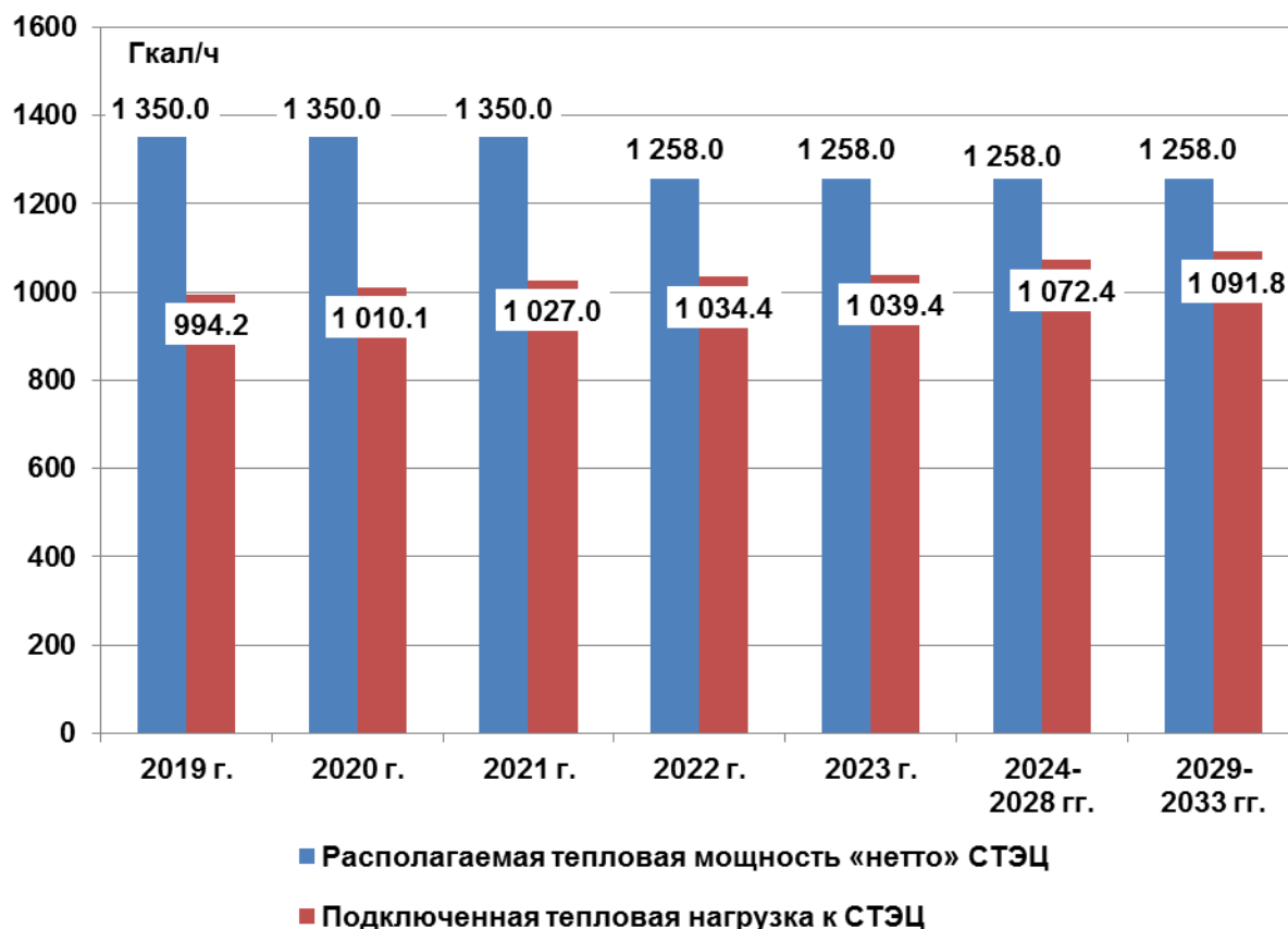
Рис. 4.2.1. Располагаемая тепловая мощность и подключенная тепловая нагрузка к Сакмарской ТЭЦ по Варианту развития № 1
