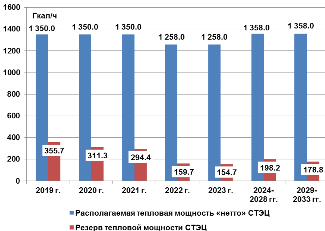
Рис. 4.1.9. Изменение резерва тепловой мощности «нетто» СТЭЦ в период 2019 – 2033 гг. при присоединении тепловых нагрузок зон нового строительства с учетом передаваемых на СТЭЦ тепловых нагрузок 6-ти котельных и ввода в эксплуатацию водогрейного котла тепловой мощностью 100 Гкал/ч
