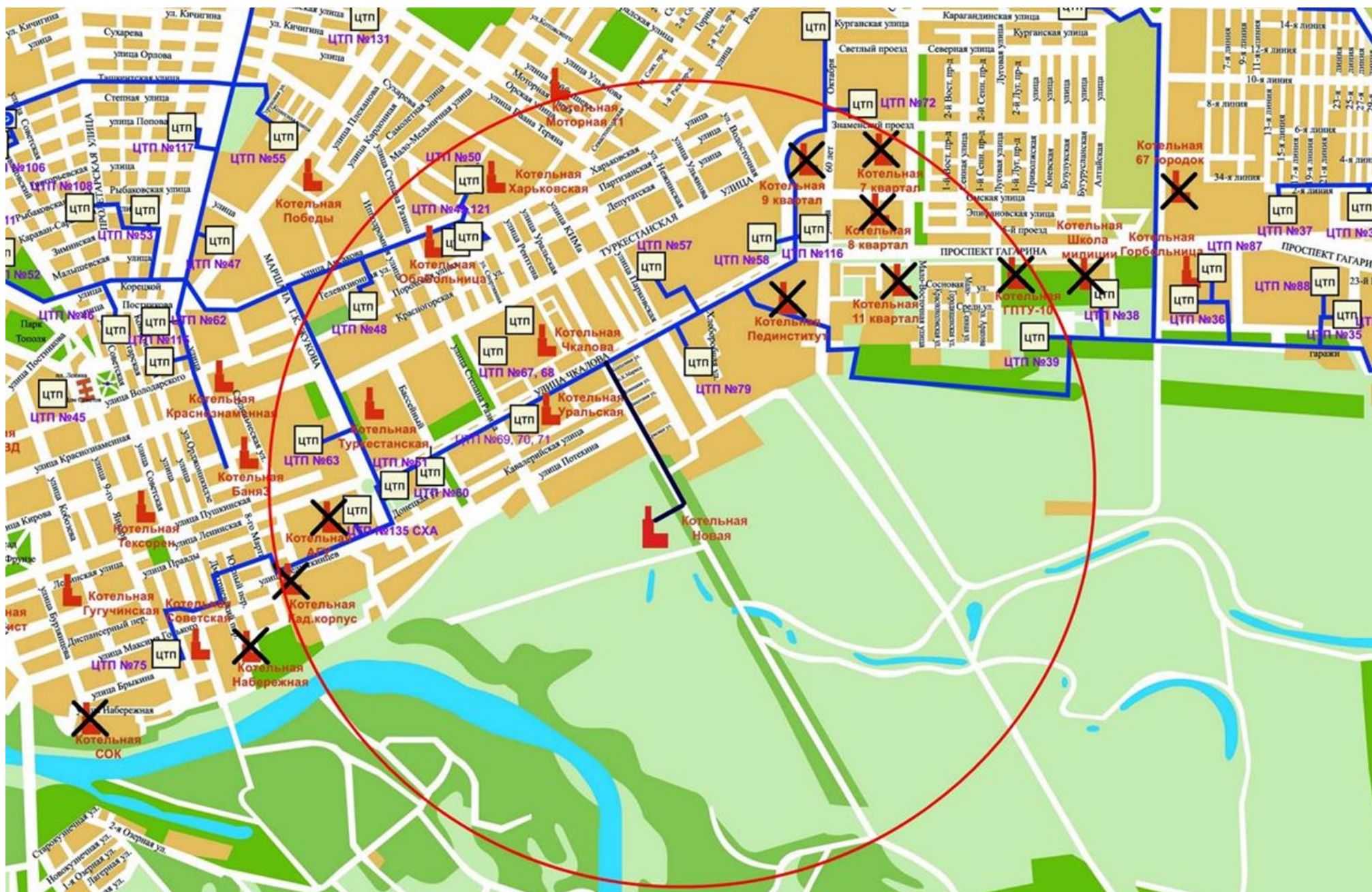
Рис. 5.3.1. Зона действия новой котельной и месторасположение переключаемых на неё 12 котельных
